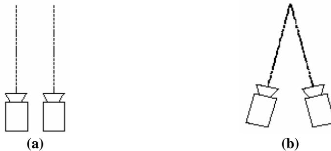
**Figura 11.8 – Configuração de Câmeras: a) Câmeras em Eixo Paralelo e b) Câmeras em Eixo Convergente (*toed in*) [Johanson, 2001].**
